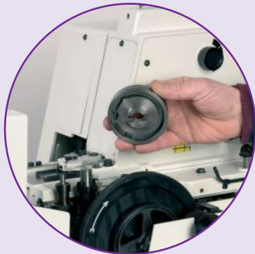
Vačky modelu BH 1000 jsou jednoduše vyměnitelné
